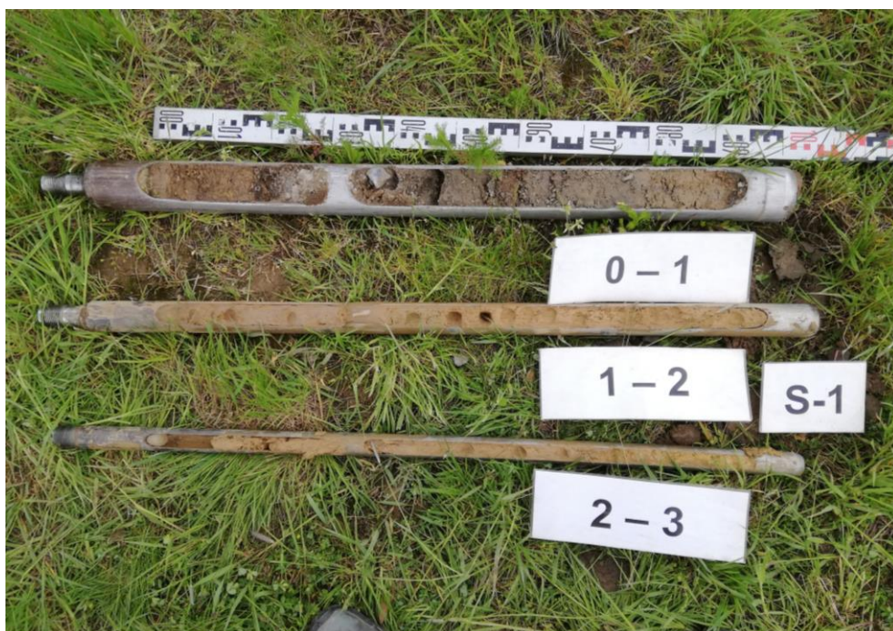
Obr. 2 Zastížené zeminy sondou S-1 v hloubce 0,0 – 3,0 m
