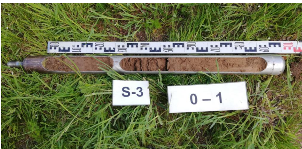
Obr. 6 Zastížené zeminy sondou S-3 v hloubce 0,0 – 1,0 m
